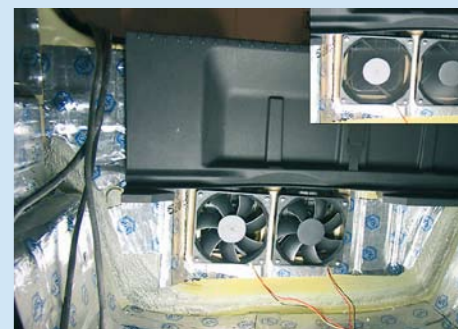
Kaksi 120-millistä Scythe S-Flex SFF21E -tuuletinta vastaa lämpimän ilman poistamisesta varapyöräkotelon poistoilmaventtiilien kautta. Tuulettimien kiinnityskaulus on tehty vanerista ja se on kiinnitetty autoon Sikaflexillä. Tietokonekäyttöön tarkoitetut laadukkaat tuulettimet ovat paitsi tehokkaita myös varsin äänettömiä.
