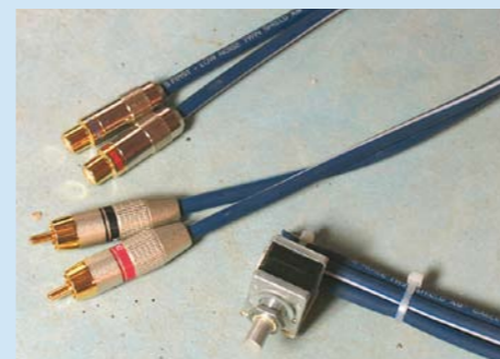
Subbarin tasojen nopea säätely onnistuu itse tehdyn säätimen avulla, joka kytketään subwooferia ohjaavan vahvistimen RCA-johtojen väliin. Valtmistukseen riittää pätkät RCA-kaapelia, pala piirilevyä, audiokäyttöön tarkoitettu ALPS:in valmistama 10 K ohmin potikka, säätönuppi, naaras RCA-liittimet sekä koiras RCA-liittimet. Katso lisää kuvia ja valmistusohjeet www.kalliojarvi.net .
