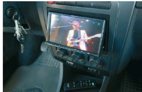
Ohjelmalähteenä toimii Alpinen uusi IVA-W505R, jossa on 7-tuumainen kosketusnäyttö ja varsin hyvät liitännät sekä erikoisuutena kannettavan navigointilaitteen telakka-asema näytön takana.
