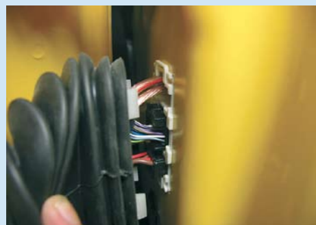
Pasi ehti jo säikähtää, kun oven haitarikumin alta paljastui autohifistien vihaama moninapaliitin, joka useasti estää kunnollisen kaiutinkaapelin vetämisen alkuperäisen läpiviennin kautta oveen. Tällä kertaa oli kuitenkin tuuria, sillä ylin liitinpaikka on tyhjä ja sen kautta oveen sai vedettyä paksumpaa kaapelia ongelmitta.
