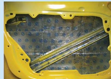
☉ Myös ovien vaimennus oli tämän projektin kohdalla tärkeää, koska midbassoelementit sijaitsevat freeairina ovissa käyttäen ovien sisäosaa kotelonaan. Ja periksi antavaan sekä resonivoivaan koteloon asennettu kaiutinhän ei voi soida hyvin. Ibizaan ovien vaimennusta helpotti pulteilla irrotettava sisäpelti, jonka Pasi käsitteli matolla molemmin puolin. Myös ulkopellin sisäpinta vaimennettiin. Kaikkiaan etuoviin upposi viitisen pakettia mattoa. Takaovetkin saivat vastaavanlaisen käsittelyn, vaikei niissä kaiuttimia olekaan.
