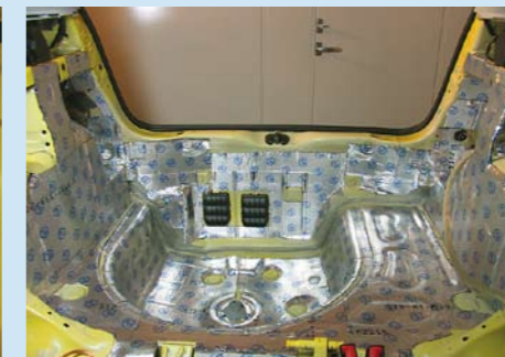
☉ Katon vaimennus sujui varsin nopeasti, kun verhoilut oli ensiksi saatu pois tieltä. Lattia olikin sitten aavistuksen hankalampi tapaus monimutkaisten muotojensa vuoksi, vaikka työskentelyasento oli kattoon mukavampi. Vaimennusmattoa lattiapintaan kuului kaikkiaan kolme pakettia, eli saman verran kuin tavaratilaan ja sen kanteen. Muovinen rautakaupasta hankittu kova tapettilehti on hyvä apuväline maton painamiseen tiivistä paikoilleen.
