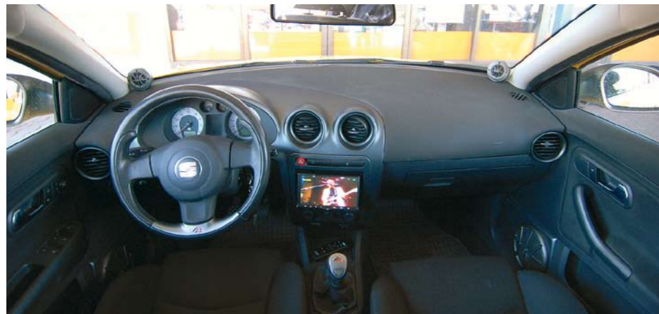
Ohjaamon yleisilme on selkeä. Diskantit suunnattuina kojelaudan päällä ja keskiäänit ovien etureunoissa. Toimii.
