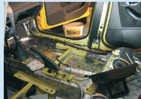
☉ Ibiza johdotus toteutettiin asiallisesti, muttei yliampuvasti. Pasi ei enää tämän jälkeen aio osallistua autollaan hifikilpailuihin, joten turha nysvääminen jätettiin väliin. Johtojen vedot edestä taakse tehtiin käyttäen avuksi auton valmiita johtokanavia. Kiinnityksissä käytettiin reilusti nippusiteitä sekä vaimennusmaton suikaleita.
