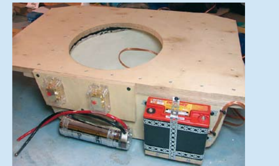
☉ Laitteiston virtajärjestelmän osia saatiin soviteltua subbarikotelon takapuskurin puoleiselle sivulle, minne jätettiin tyhjää tilaa niitä varten. Odysseyn pieni PC 680 akku yhdessä Faradin kokoisin kondensaattorin kanssa tasaavat hyvin päätteiden virransaantia. Subbarikotelon kaiutiinjohdon läpiviesti tehtiin poraamalla reikä akun viereen. Tiivisteenä toimii Sikaflex.
